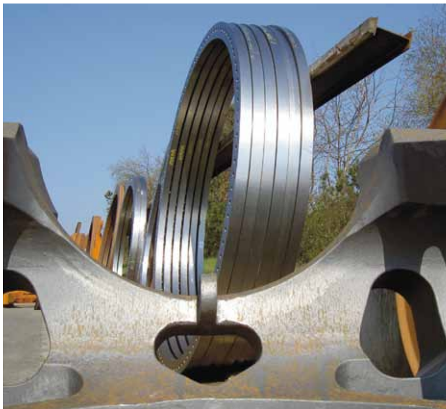
Flänsar används för att sammanfoga delar till ett vindkraftverk. De kan ha en diameter om upp till åtta meter och väga upp till 15 ton.
